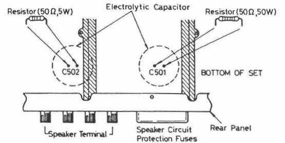
■ HOW TO REMOVE THE POWER IC
